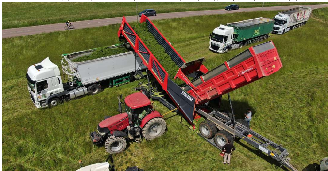
Trans-eXpress 3000 został zaprojektowany przede wszystkim do prac kiszonkowych. Ciężarówki pozostają na skraju pola i są ładowane przez przyczepy rolnicze.
