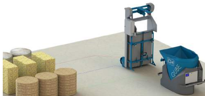
Robot pobiera składniki paszy wg zaprogramowanego planu żywienia.
